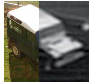
94 GHz Radiometer
